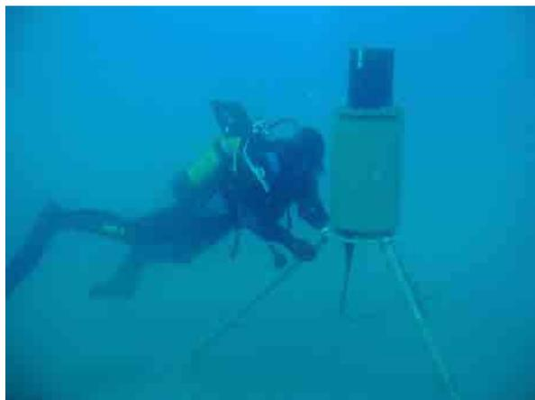
El sonar **DDS-03**, ha sido verificado y validado con éxito en una amplia variedad de entornos operacionales: despliegue desde buques fondeados, instalación fija en el fondo marino, protección de puertos, detección de buceadores de ciclo abierto y ciclo cerrado, etc.
