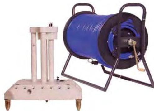
MIRS proporciona medidas reales de todas las influencias de un buque (magnética, eléctrica, presión, acústica y sísmica) simultáneamente en un escenario real y controlado, para contrarrestar con éxito amenazas.
