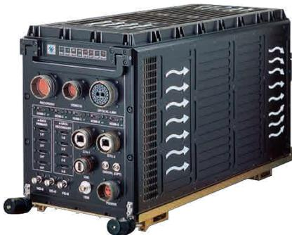
SPAS es la solución más versátil para el procesamiento de sonoboyas en plataformas ASW. El sistema cuenta con avanzadas tecnologías y algoritmos de procesamiento exclusivos de SAES que automatizan la detección y clasificación de amenazas, reduciendo la carga del operador y optimizando la eficiencia de la misión.
