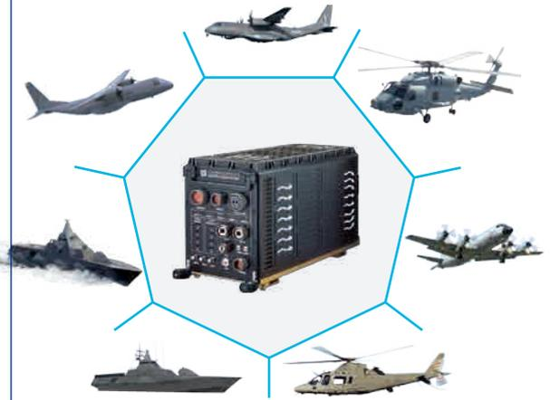
*SPAS es el único procesador acústico de sonoboyas que se fabrica ajustado totalmente a las necesidades del cliente en cuanto a requerimientos de la plataforma ASW, tipo (y sub-tipo) y número de sonoboyas y tipo de operación.*
