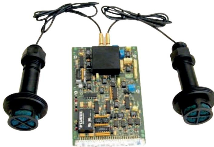
**SAES** ha diseñado y fabricado el sensor de campo eléctrico **SET-200/P** para medir el campo eléctrico en el medio marino. Se trata de un dispositivo de precisión, de ultra bajo ruido, que permite la medición de campos eléctricos de muy bajo nivel.
