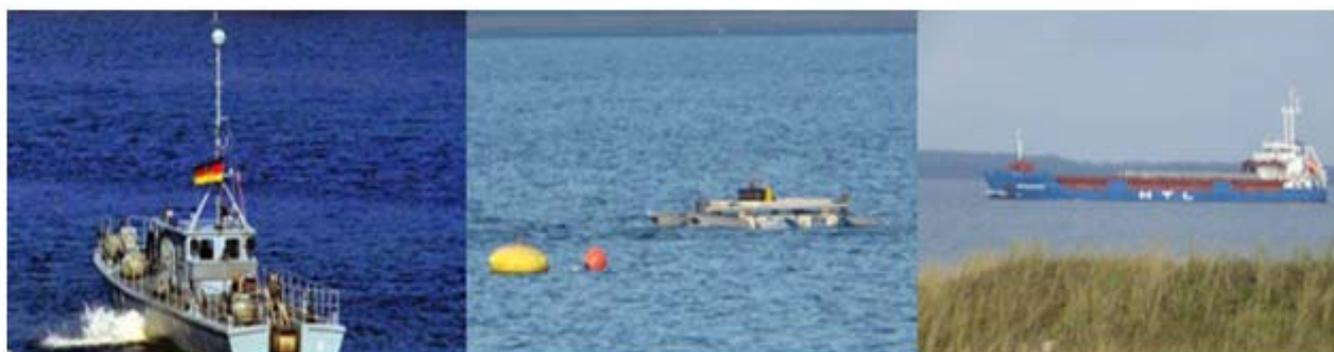
Fuentes de señales multi-influencia para las medidas de calibración en Aschau: embarcación Seehund (izqda.), fuente calibrada PRIME (centro) y buque mercante (dcha.)
