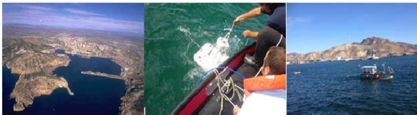
Figura 11 Medidas de calibración con el sistema PRIME en el entorno del Puerto de Cartagena: Área de medidas (izqda.), despliegue del sistema MIRS en el área de medidas (centro) y embarcación remolcando la fuente calibrada PRIME (dcha.)
