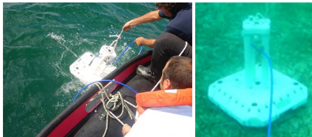
Figura 2. Sensor submarino Multi-Influencia (USU) durante el despliegue (izquierda) y desplegado en el fondo del mar (derecha).
